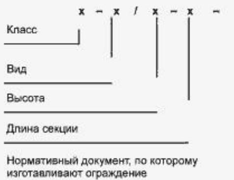
*Пример обозначения основной части маркировки пешеходного и защитного ограждения: УПО-Д*
